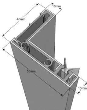
Waterkeringsprofiel / Profilé d'échanchéité
