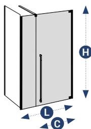
Porte pivotante à 90° avec panneau fixe et profilé d'étanchéité au sol
