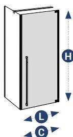
Porte pivotante à 90° avec profilé d'étanchéité au sol
