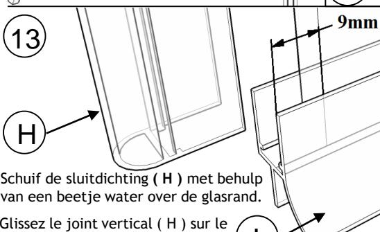
Schuif de sluitdichting ( H ) met behulp van een beetje water over de glasrand.
